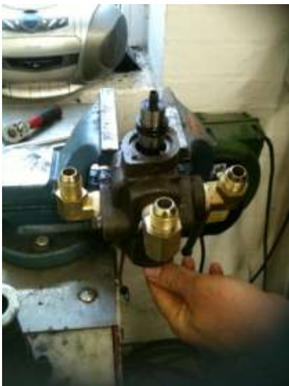
Skub ventilstangen op.
