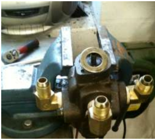
Tag et tyndt stykke jern, eller skruetrækker, og vippe skiven op.
